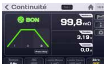
Test Bon terminé
