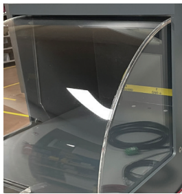
Cylindre de protection en acrylique translucide avec poignée de manoeuvre
