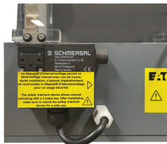
Système de sécurité à l'ouverture ou verrou électromécanique de la porte
