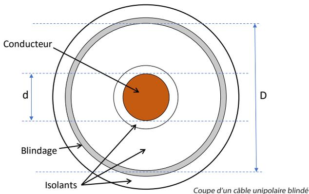
Cette capacité parasite est généralement exprimée par des grandeurs linéiques, l'unité utilisée étant un sous-multiple du Farad par kilomètre.
