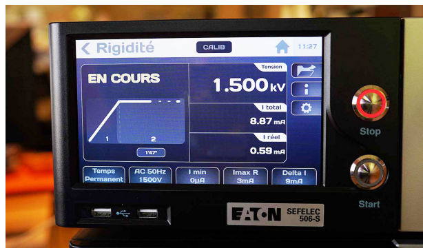
SEFELEC 506-S en cours de mesure de rigidité avec affichage du courant total et du courant réel
