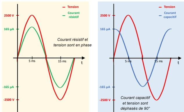
Le courant de fuite qui est mesuré par la plupart des appareils d'essai de rigidité diélectrique correspond à la somme vectorielle (racine carrée de la somme des carrés) du courant réactif (courant capacitif) et du courant réel (courant résistif). Le courant résistif est lié à la résistance d'isolement et à la tension appliquée sur l'élément testé.
